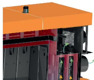
**La facilité du chargement bois :** « Le Tunnel d'échappement » en partie supérieure aspire automatiquement les gaz de combustion en cas de chargement. Dès que vous ouvrez la porte de chargement, l'extracteur déclenche sa vitesse supérieure aspirant les fumées en suspension dans le foyer et vous permet de faire le chargement sans aucune gêne.
