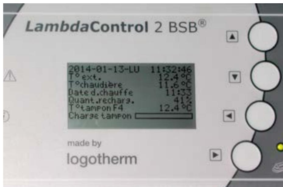
La régulation Lambdacontrol reconnaît les phases de départ et de fin de combustion et vous indique le besoin de rechargement bois par un signal lumineux.
