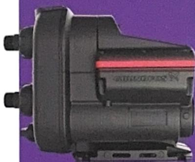
vitesse, ce surpresseur permet de réduire sa consommation d'énergie jusqu'à 40 %, annonce le fabricant. Tout-en-un, il contient une pompe, un moteur, un réservoir, un capteur et un clapet anti-retour dans une unité compacte. En cas de chute de température, la pompe signale le risque de gel et s'auto-protège pour atténuer les premiers effets et permettre ainsi à l'utilisateur de réagir promptement et la mettre à l'abri du gel.
